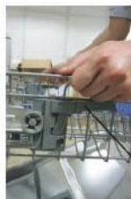
Рис. 1 Для подъема корзины потяните ее вверх.
